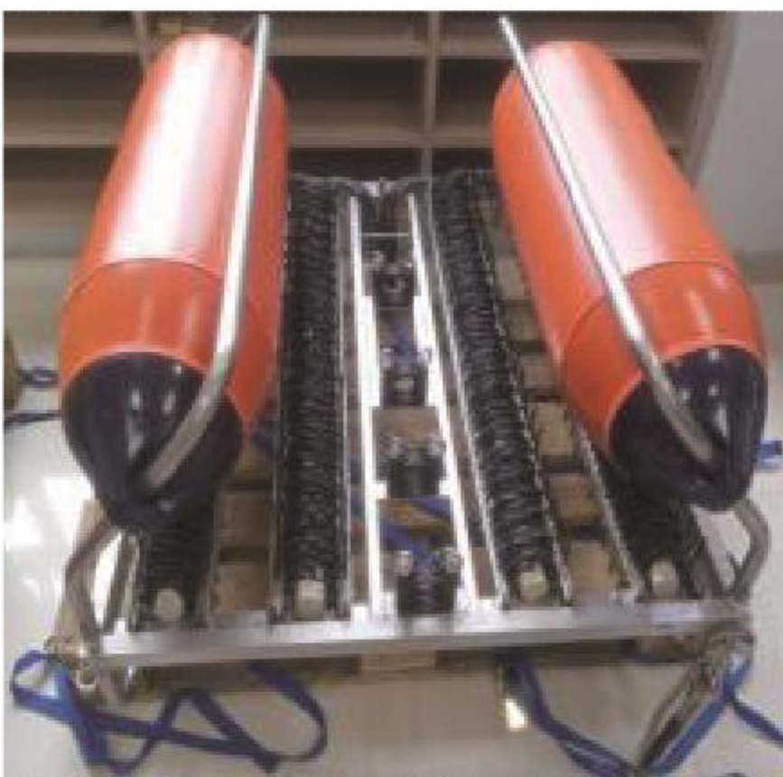
荷兰 GEO Spark-2KJ 单道电火花勘探设备
