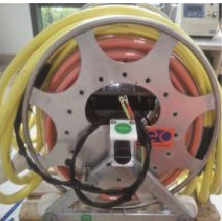
荷兰 GEO Spark-2KJ 单道电火花勘探设备
